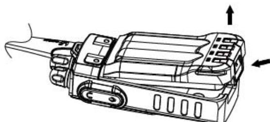
欲取下电池，请先关闭手持终端电源，然后将手持终端背面底部的闩锁向上推，将整块电池往上提取出电池。
