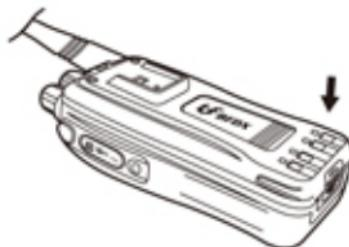
取下电池组时，按下对讲机背面底部的闩锁，水平向上从对讲机底部取出。
