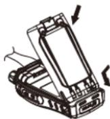
取下电池时，先把对讲机关闭，然后将对讲机背面对讲机中脱
