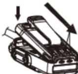
欲取下电池，请先关闭对讲机，然后将对讲机背面顶部的闩锁向下推，使电池的顶端从对讲机中脱出，然后将电池取下。
