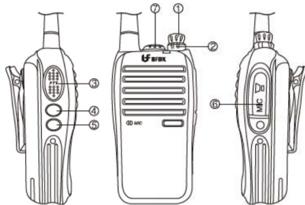
① Power (电源) 开关—Volume (音量) 控制器
