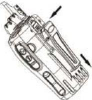
取下电池时，先把对讲机关机，然后将对讲机背部顶部的闩锁往上推，使电池的顶端从对讲机中弹出，然后将电池取下。
