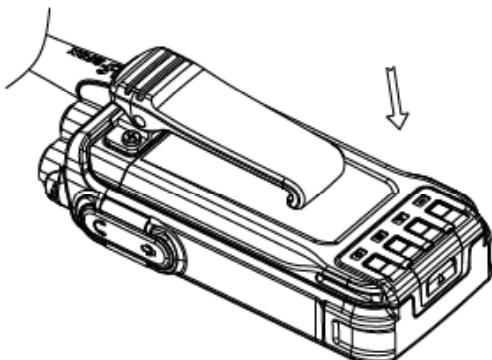
欲取下电池，请先关闭手持终端电源，然后将手持终端背面底部的闩锁向上推，将整块电池往上提取出电池。
